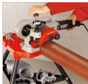
V použití s drážkovacím zařízením ROGROOVER
