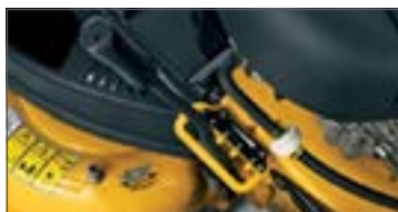
Centrální nastavení výšky sečení
