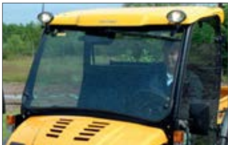
Stabilní kabina s předním sklem a stěračem. Volitelně je k dispozici topení a dveře.
