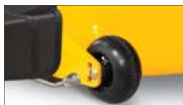
Dotyková kolečka žacího ústrojí Anti Scalp
