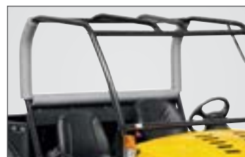
Pevný kabinový rám v případě převrácení vozidla
