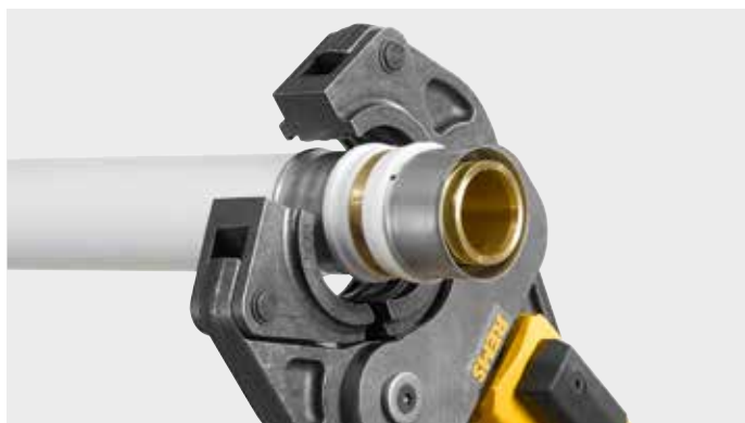
REMS lisovací kleště (S) s jedním pevným a dvěma kloubovými výklopnými lisovacími segmenty, pro středně velké dimenze.
