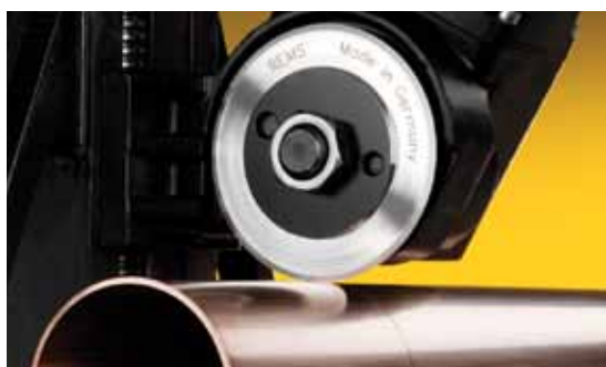
Řezná kolečka REMS jsou přizpůsobena speciálním požadavkům různých materiálů. Obzvláště speciální postup kalení rozhoduje o dlouhé životnosti řezných koleček REMS.
