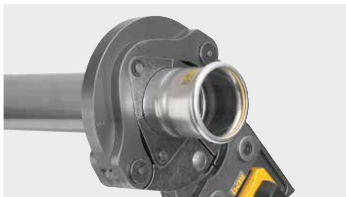
Lisovací kroužek (PR-3S) REMS s 3-mi na kloubovém kroužku vedenými výklopnými lisovacími segmenty pro lisování velkých dimenzí s vysokými požadavky. Optimální lisování díky radiálně řízenému pohybu lisovacích segmentů, s mezikleštěmi.
